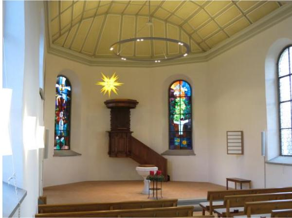
Im Juli wurde die Kirche ausgeräumt und mit den **Renovationsarbeiten** begonnen. Es wurden die Decke gedämmt und gewaschen, die Wände gestrichen, neue Lampen und ein Lichtring über dem Chor installiert. Die Sitzbänke bekamen Holzlehnen und neue Polster, die Mesmerin kann Licht und Geläut über ein Steuerpult bedienen und viele Dräh-
